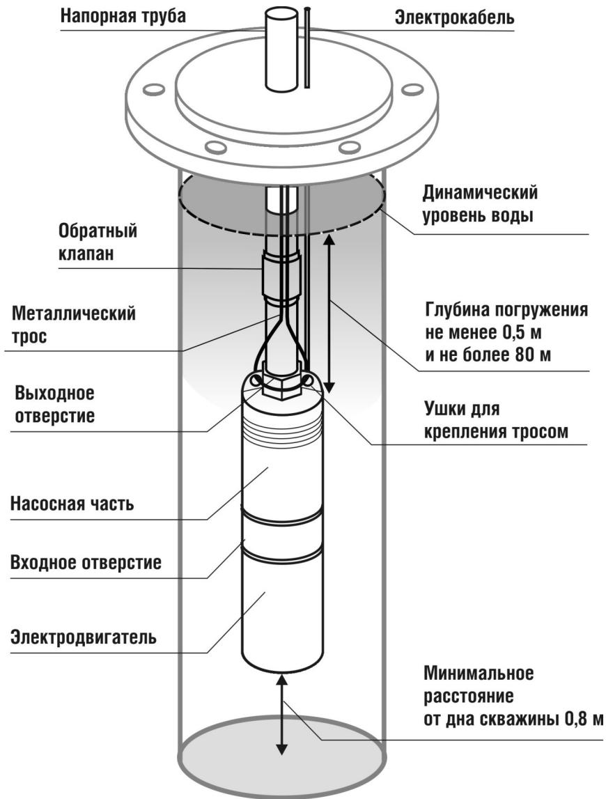
Схема расположения насоса в скважине
