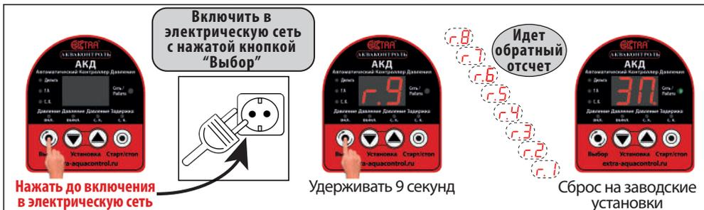
**ВНИМАНИЕ!** При отключении сетевого напряжения АКД сохраняет все настройки. При восстановлении сетевого напряжения реле включится в работу согласно последним установленным настройкам. При этом все аварийные режимы будут сброшены, а таймеры начнут новый отсчет времени.
