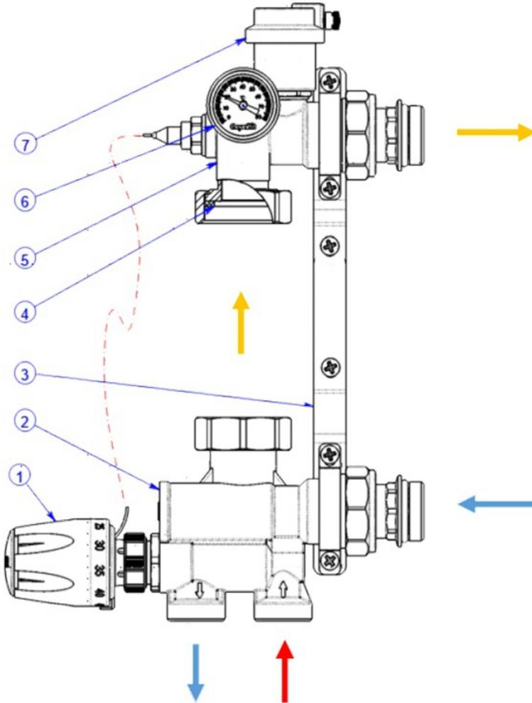
Вход высокотемпературного теплоносителя происходит справа снизу (стрелка вверх). В нижнем корпусе (2) происходит смешивание высокотемпературного теплоносителя системы отопления и теплоносителя с обратной линии низкотемпературного контура (боковой нижний вход).
