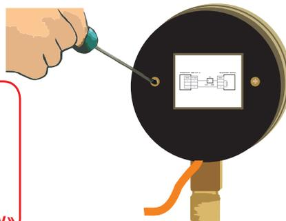
Подсоедините сигнальный кабель (входит в состав прибора) к клеммнику манометра АДМ-100.3
