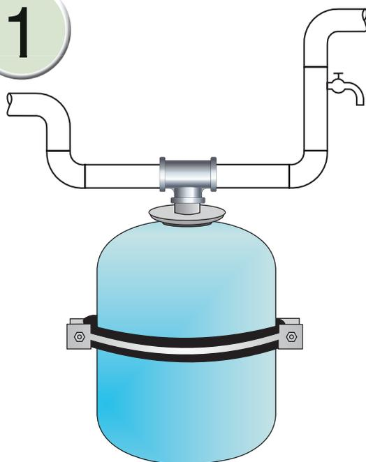
При монтаже водопровода подключите к нему гидроаккумулятор
